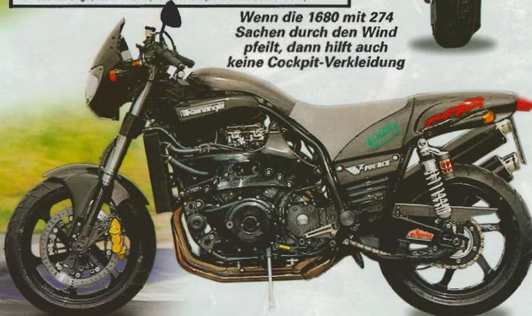
*Riesige Aluminium-Profile und die starre Verbindung des V4-Motors mit dem Rahmen sorgen für hohe Stabilität und dadurch für ein sehr direktes Fahrgefühl*
