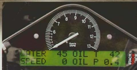
**Am sündhaft teuren Stack-Instrument können alle motorrelevanten Daten abgerufen werden**
