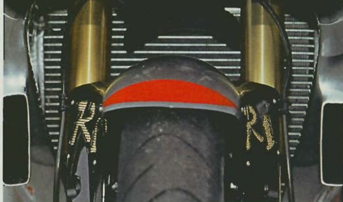
Dieses Ram-Air-System macht sich positiv bemerkbar. Die Öhlins-USD-Gabel harmonisiert perfekt mit dem Yamaha-Chassis
