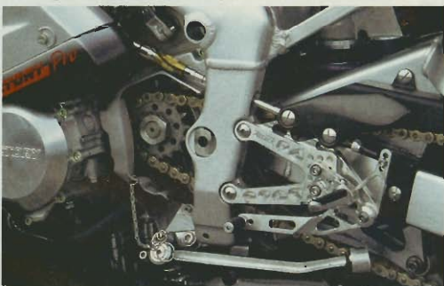
Ein Leichtgewicht ist der Seitenständer, die Rastenanlage brilliert durch viele Einstellmöglichkeiten und wenig Masse
