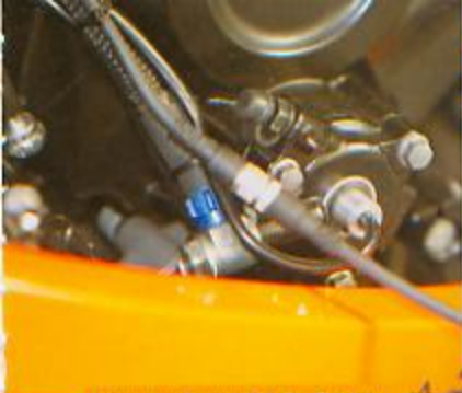
Lohmanns Spezialität: Die Elektrohydraulische Kupplung. Hier der modifizierte Ausdrücker...
