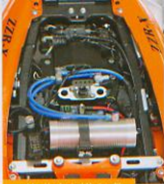
...und im Heck sind Hydraulik-Einheit nebst Steuergerät verstaubt.
