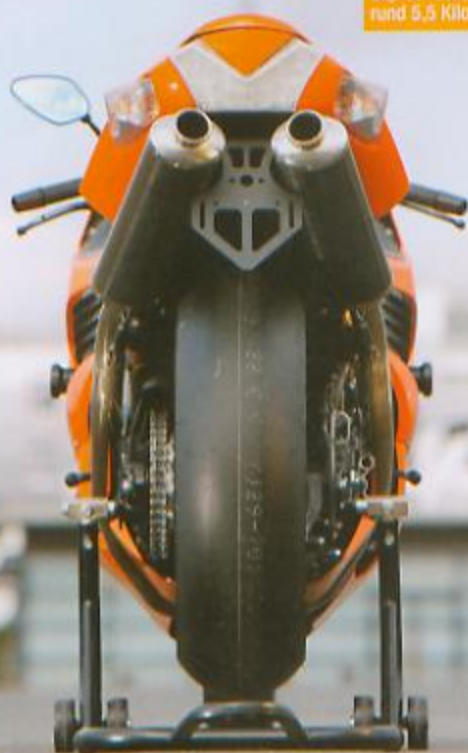
Bulliges Heck mit federleichtem Tüten-Duo. Allein die Motace-Slip-On-Schalldämpfer sparten rund 5,5 Kilo.
