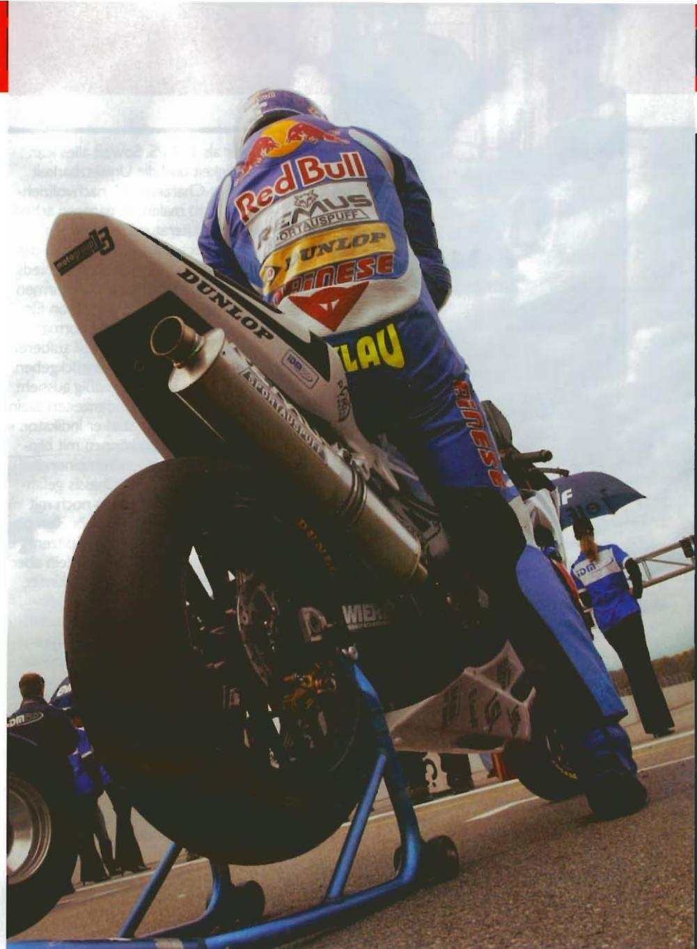
Nockenwellen ist also voll auf der sicheren sorgfältigen Seite. Rund fünf PS fehlen auf die hochdrehende Meklau IDM-Maschine am Spitz, aber unser Motor schlägt sie um fünf PS in der Mitte am Kurvenausgang.
