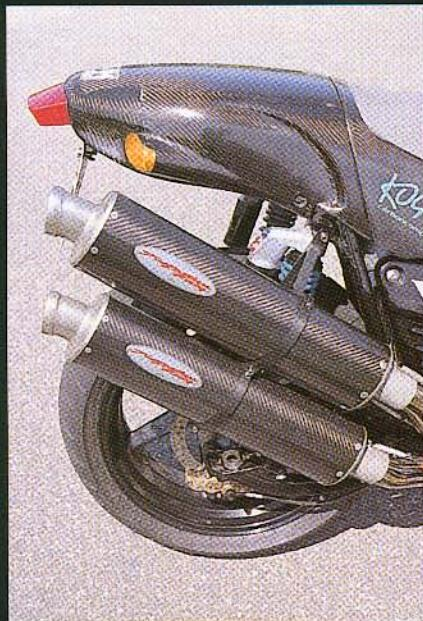
Hyperpro 轉向制動器、大量的碳纖材質零件以及相當輕盈的車身都使得這部 Max 純人感覺有十足的跑車味道。同樣重要的特點還包括了那副大引擎哽咽的 V4 哟音，以及它那鈦質連桿和輕盈的發電機。
