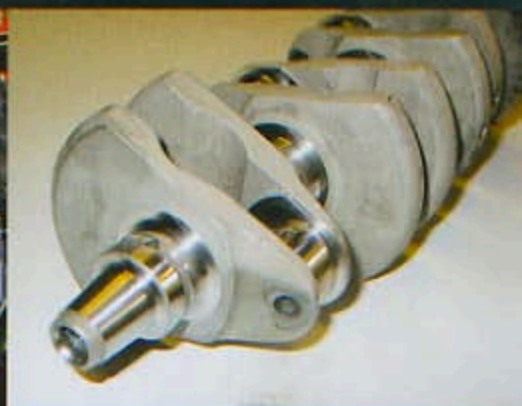
Trotz größerem Hub ist die Kainzinger-Welle leichter als die Serie.
