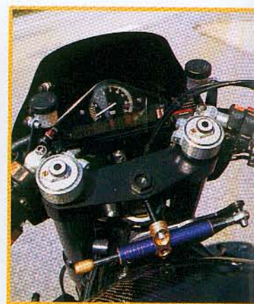
Instrumental tan vanguardista como la K-Max y un amortiguador de dirección para evitar meneos indeseados.
