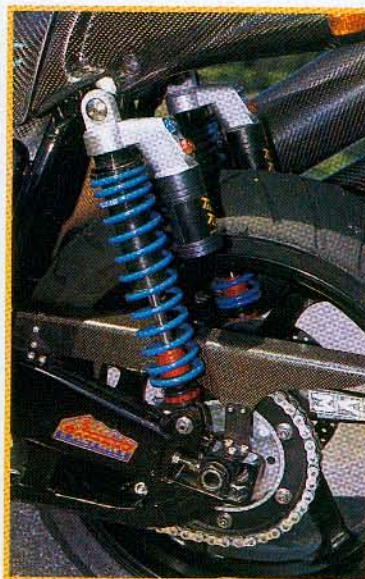
Transmisión final por cadena, basculante de aluminio y amortiguadores dual TechnoFlex.
