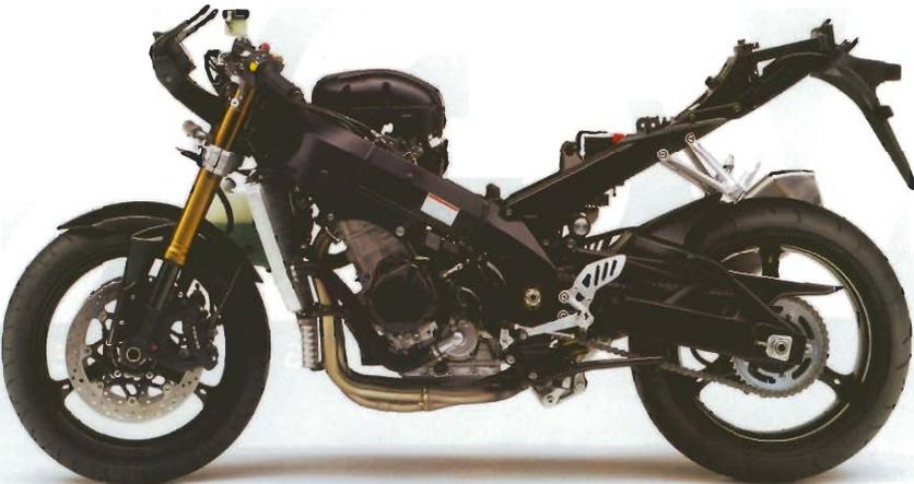
Unverkleidet sticht die neue GSX-R Konstruktion mit ultrakompaktem Aufbau. Wenn man sich die Straßendeckverlängerung wegdenkt, gibt's keine Gänge.
